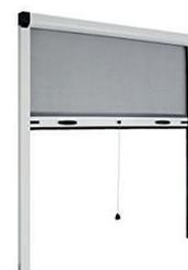
Moustiquaire enroulable manuelle avec toile PVC et profilé en aluminium extrudé. Barre de charge équipée d'un joint brossé en partie basse, avec système réglable de blocage en partie basse des coulisses. Coulisses anti-vent haute densité avec double joint brossé.
