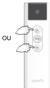
Sélectionner le moteur sur lequel la nouvelle commande sera ajoutée, en appuyant sur MONTEE ou DESCENTE
