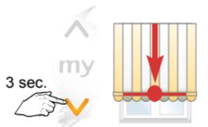
Appuyer jusqu'à l'arrêt du moteur
