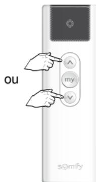
Sélectionner le moteur sur lequel la commande doit être supprimée, en appuyant sur MONTEE ou DESCENTE
